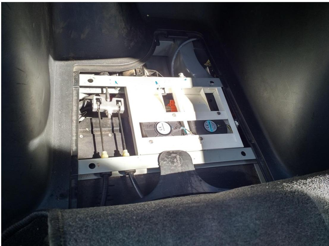
Der komplette Rahmen wird in das vordere U-Profil vom Twizy eingeschoben.
