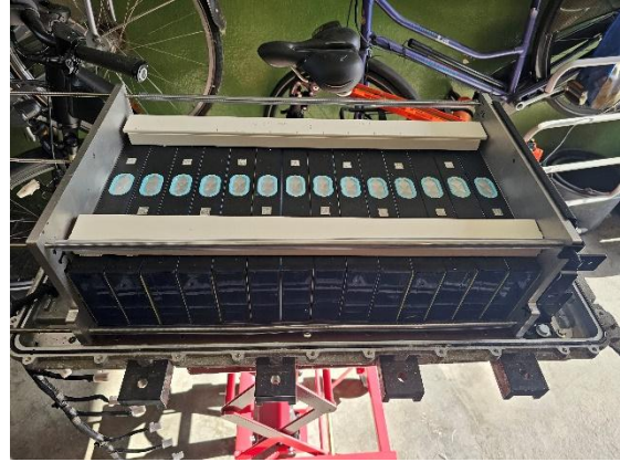
Polabdeckung über alle Zellen mit kabelkanal
