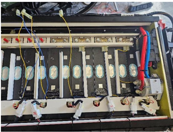
Zellverbinder mit aufgelöteten Flachsteckern
