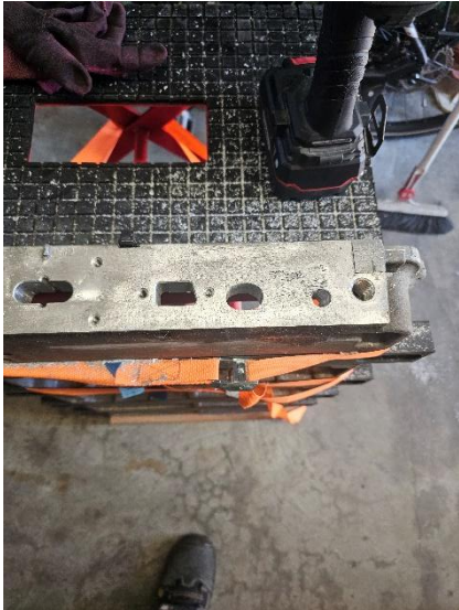
Zusätzliche Bohrungen neben der Steuerbuchse
