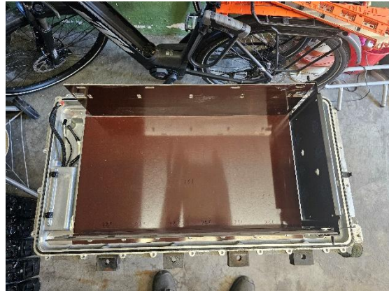
Leere Akkubox mit den lose eingelegten Frästeilen
