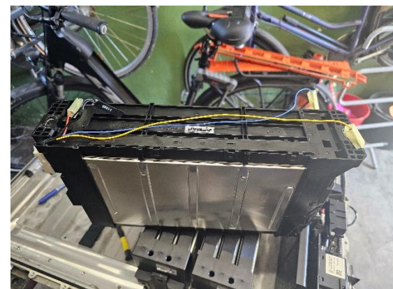
BMS-Kabel aus den Akkupacks entfernen
