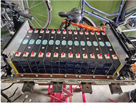
Neue Zellen mit 0,5mm GFK Trenner
