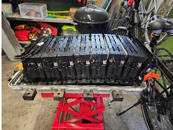
Pluspol jedes Akkupacks isoliert und Halteschrauben gelöst
