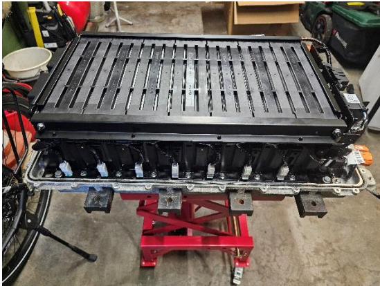
Akku geöffnet, Seite mit den BMS Steckern
