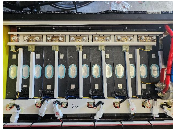
Alle Kabel in Kanälen. Schrauben sind mit Flüssiggummi gesichert. Drehmoment der Muttern auf den Zellen 3,5Nm
