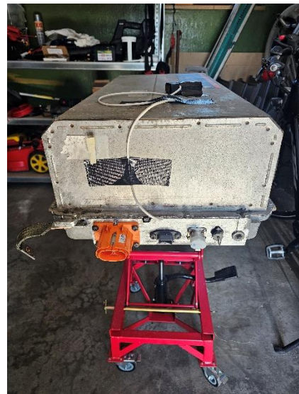
Die Einbaufertige Akkubox mit Achluß für Zusatzlader und Steuereingang für den Ladeschutz
